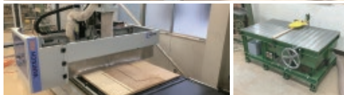
ネ스팅専用 NCルーター (HOMAG) 椅子脚カット加工機 (オリジナル特注機)
